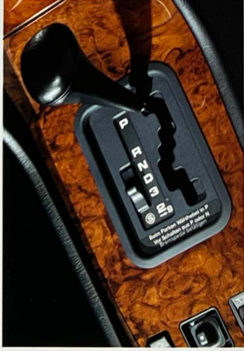
Die serienmäßige 4-Gang-Automatik verfügt über zwei Fahrprogramme, S wie sportlich und E wie Economy. Die Beleuchtung der Wählhebelkulisse informiert Sie über die eingelegte Fahrstufe.
